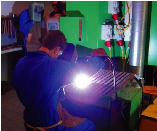
Figuur 2-20: Met een laskap bescherm je je ogen tijdens het lassen.
